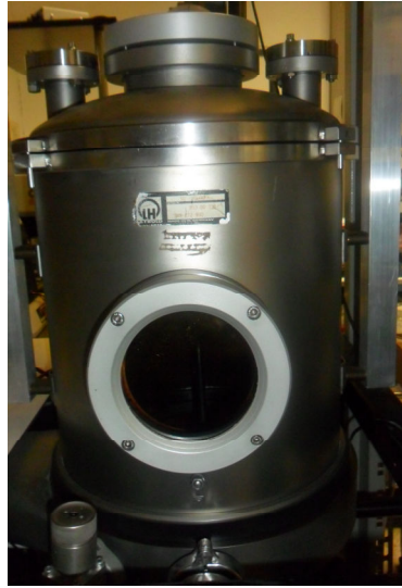
Figura 3.11- Campana d'acciaio in cui avviene la deposizione dei contatti di oro di Drain e Source.
